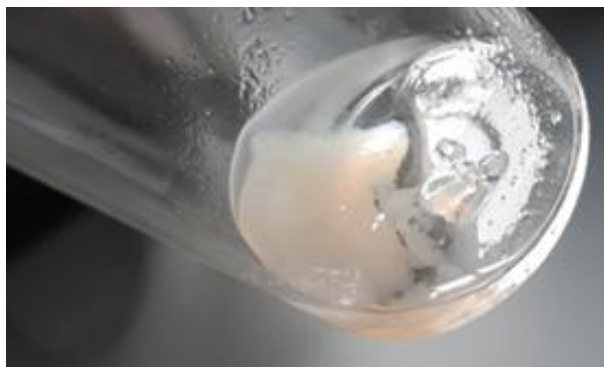
Rysunek 76 Rozwarstwienie tuszu podczas pierwszej nieudanej próby użycia tuszy półprzewodnikowych.
