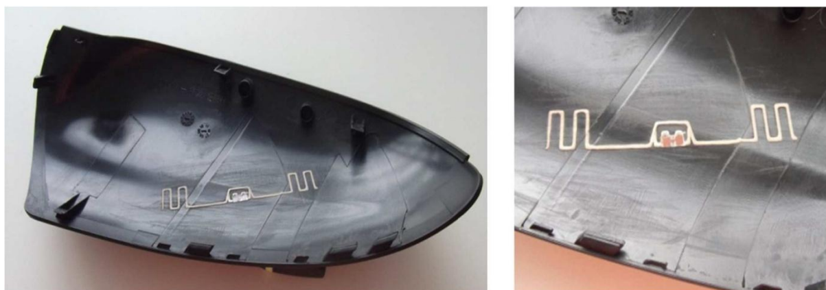
Rysunek 28 Drukowana antena dipolowa do pracy w ultrawysokich częstotliwościach z chipem RFID na plastikowej obudowie lusterka samochodowego [399].
