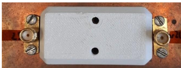
Rysunek 34 Uchwyt testowy do pomiarów linii transmisyjnych
