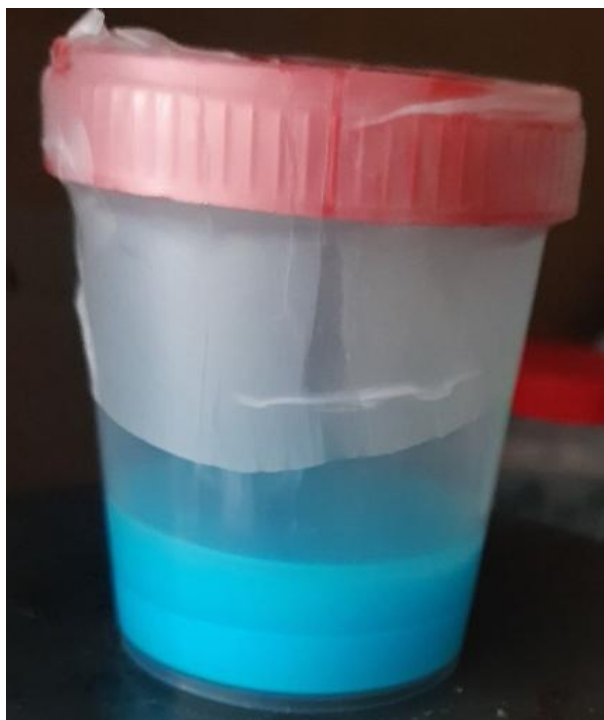
Rysunek 74 Tusz na bazie mrówczanu miedzi podczas mieszania, widoczne nie pełne nasycenie roztworu mrówczanem miedzi.
