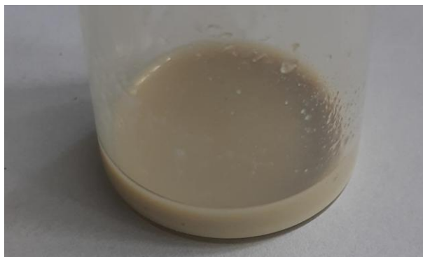
Rysunek 75 Tusz IGZO po ujednordnieniu w atomizerze ultradźwiękowym.
