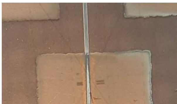
Rysunek 78 Linia srebrna nadrukowana poprzez krawędź miedzianego pola lutowniczego.
