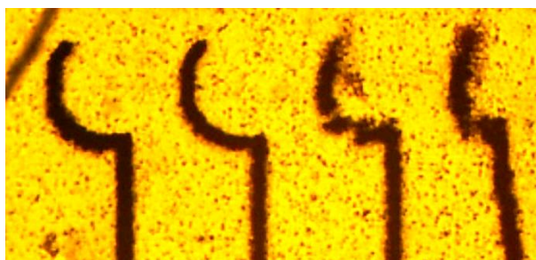
Rysunek 63 próbki pojedynczych warstw łuków wykonanych z prędkościami 0,1, 0,2, 0,5 i 1 mm/min.
